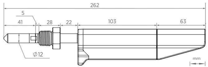
带 NPT1/2" 螺纹的 DMP80 系列探头的尺寸
